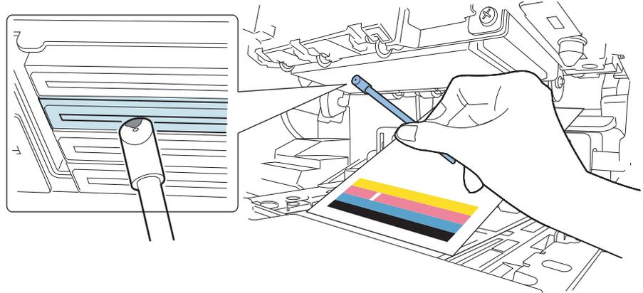
**Precaución:** No toque la sección de corte del palillo de limpieza en la parte frontal del cabezal de impresión. No toque la superficie del cabezal de impresión con la mano.
