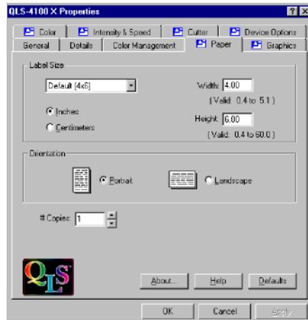
4 Klicken Sie auf die Indexzunge „Device Options“ (optionale Zusatzeinrichtungen). Falls eine optionale Schneid- (*Cutter*) oder Schneid-/Stapelvorrichtung (*Cutter/Stacker*) benutzt wird, müssen Sie das Feld „Enable Cutter“ markieren. Falls das RibbonRation-System benutzt wird, müssen Sie das Feld „Enable Ribbon Ration“ markieren.
