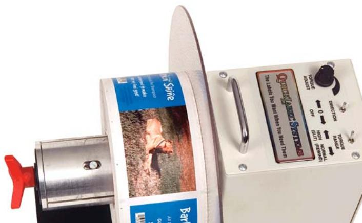
Le moteur de la rembobineuse est doté d'un réglage du couple de serrage, qui permet de s'assurer que le support est enroulé à vitesse qui convient, sans trop tirer sur les étiquettes, ce qui risquerait de causer un effet de trainage. La rembobineuse tourne dans le sens indiqué par l'interrupteur à bascule de Direction. Le moteur est arrêté lorsque l'interrupteur de Direction est sur « 0 ».
