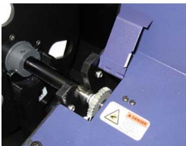
Soulevez l'arbre et les collerettes en un seul bloc. Pour soulever l'arbre plus facilement, vous pouvez le tourner légèrement vers l'arrière par rapport à l'imprimante, pour dégager les engrenages.
