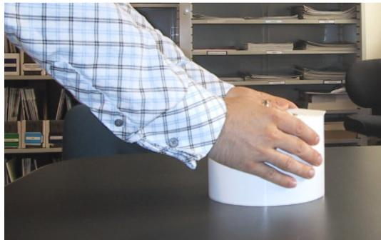
Assurez-vous que les étiquettes sont alignées, ne sortent pas de la bobine et ne se « télescopent » pas. Si les étiquettes sont bien alignées sur le mandrin enrouleur, l'impression donnera de bons résultats.
