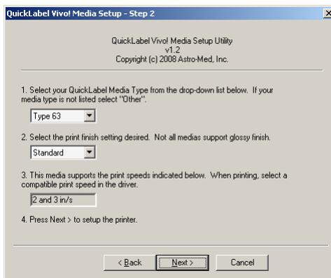
Sélectionnez le type de support QuickLabel que vous souhaitez utiliser. Ensuite, sélectionnez le fini souhaité. Tous les types de support ne prennent pas en charge le fini brillant. Les vitesses d'impression compatibles avec votre combinaison de type de support et de fini sont indiquées.
