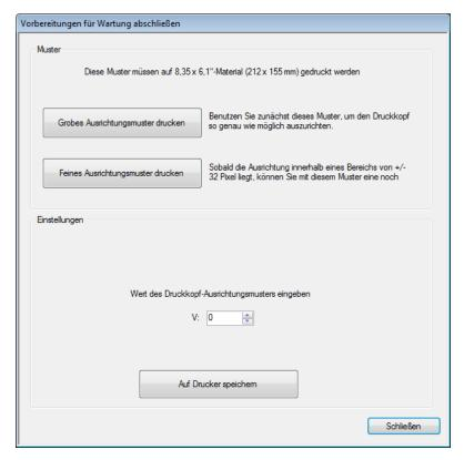
Dieses Fenster stellt ein Muster für die Grob- und Feinausrichtung zur Verfügung. Beginnen Sie mit der Grobausrichtung und stellen Sie die Druckköpfe so gut wie möglich ein. Benutzen Sie anschließend die Feinausrichtung, um eine präzise Einstellung vorzunehmen.
