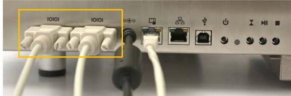
L'ordre des ports série n'a pas d'importance. Le dérouleur et la rembobineuse peuvent être connectés indifféremment au premier ou au deuxième port série. L'imprimante QL-240 détecte et identifie automatiquement les bobineuses.
