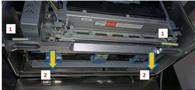
La barre transversale est fixée par 2 loquets situés sur la partie interne de la barre. Tirez les deux loquets vers le milieu (1) et retirez la barre transversale.
