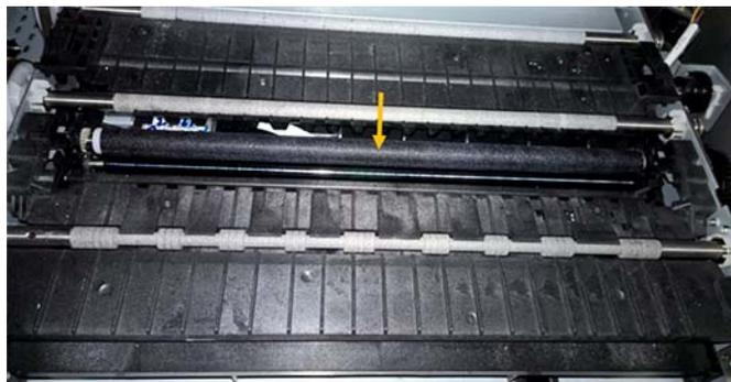
Le rouleau racleur se relève et tourne doucement. Procédez à l'inspection visuelle du rouleau racleur. Retirez toute particule susceptible de s'être collée sur le rouleau et d'endommager les buses de la tête d'impression. Assurez-vous de l'absence de tout dégât visible sur le rouleau et assurez-vous que la surface du rouleau en microfibre est toujours « pelucheuse ». Si la surface du rouleau est brillante, il est recommandé de le remplacer.
