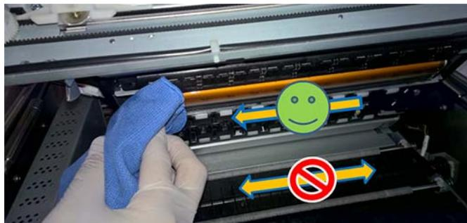
**Remarque:** Le nettoyage doit toujours être effectué en un seul passage d'une extrémité à l'autre. Ne passez jamais le chiffon d'avant en arrière, car cela risquerait de redéposer de l'encre usagée sur les buses de la tête d'impression et ainsi de causer une contamination des couleurs.
