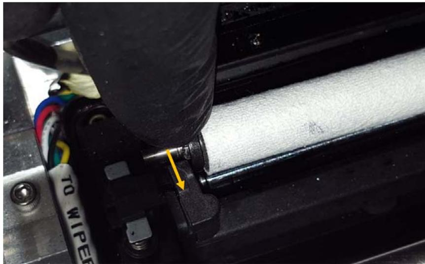
5 Premere il pulsante **Inserisci modulo di pulizia** nella **scheda TrojanTwo > menu Manutenzione** per reinserire la vaschetta di manutenzione nella posizione corretta, dove protegge la testina di stampa.
