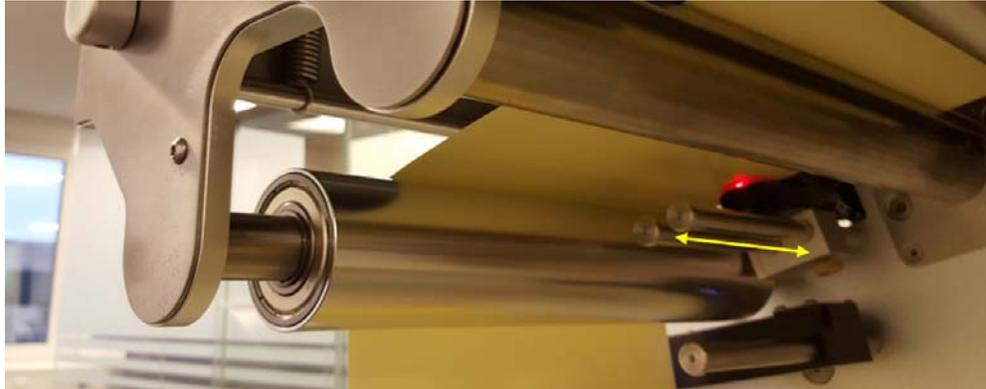
Sensore Label Eye per il rilevamento di tacche nere e gap delle etichette. Il sensore può essere spostato manualmente lungo le 2 barre (indicate con la freccia gialla nell'immagine qui sopra).
