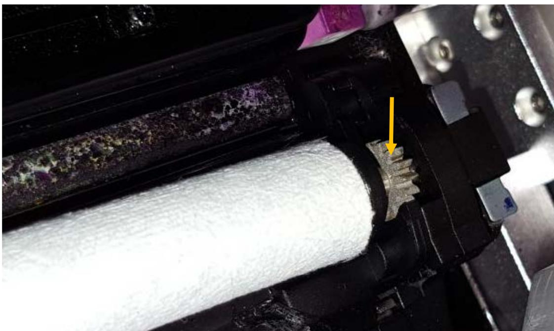
*Placez l'engrenage à l'extrémité droite du rouleau en microfibres, à l'endroit approprié, par le dessus. L'engrenage doit s'adapter à celui du moteur du rouleau racleur.*
