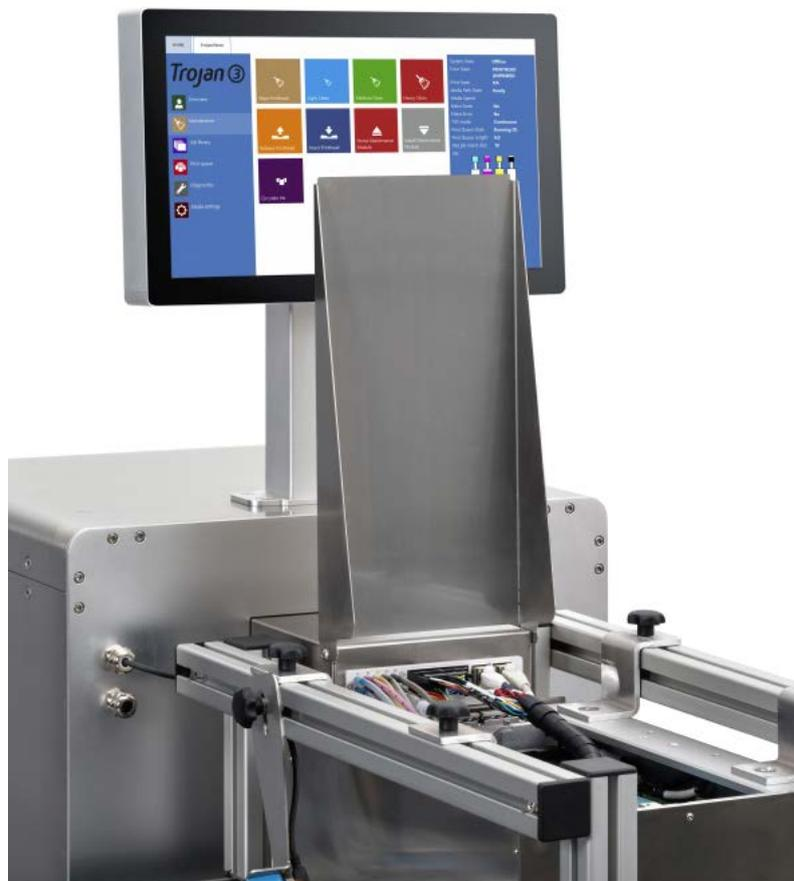
2. Appuyez sur le bouton Module de maintenance en position d'origine dans le menu Trojan3 -> Maintenance pour accéder au module du rouleau racleur :
