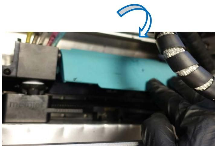
7. Appuyez sur le bouton Insérer tête d'impression dans le menu Trojan3 -> Maintenance pour amorcer la tête d'impression en encre. Cette opération peut durer jusqu'à 5 minutes.
