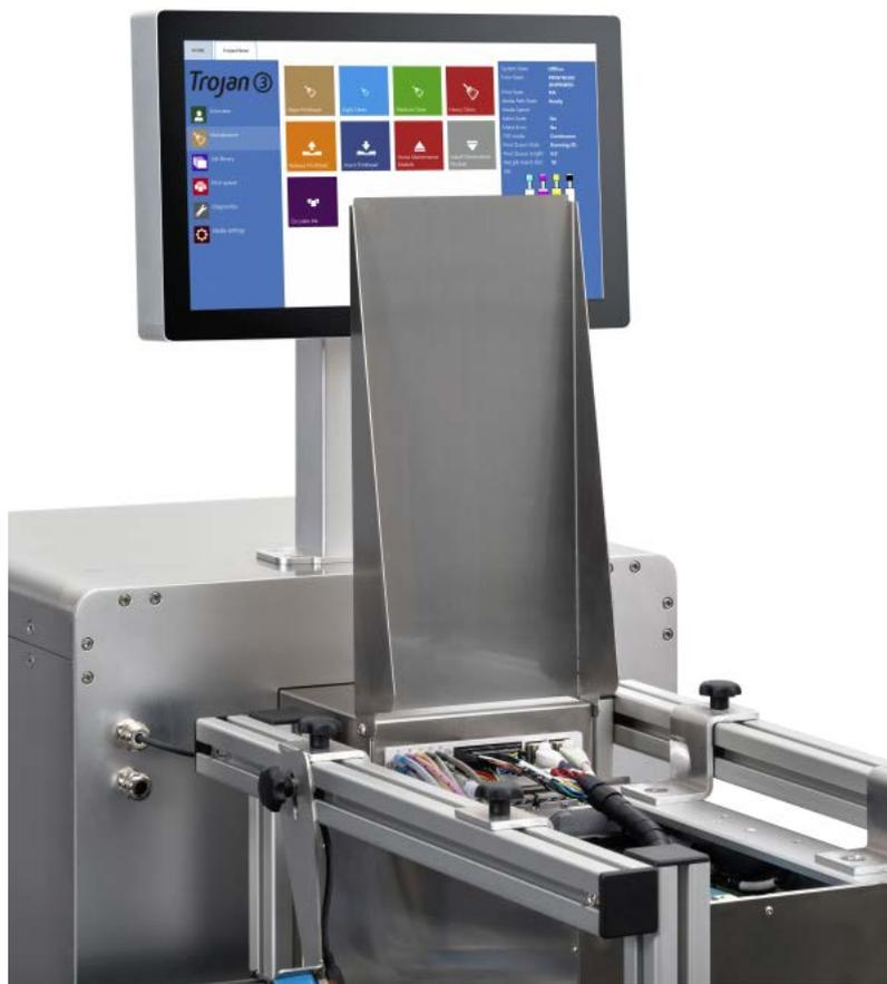
2. Appuyez sur le bouton Libérer tête d'impression sur l'onglet Trojan3 -> Maintenance pour ouvrir le loquet de la tête d'impression :
