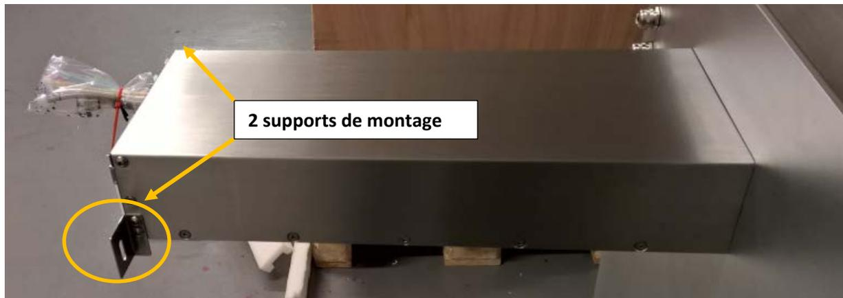
Après avoir fixé les supports de montage, vous pouvez installer le module du moteur d'impression sur ces derniers en utilisant 1 vis de chaque côté.
