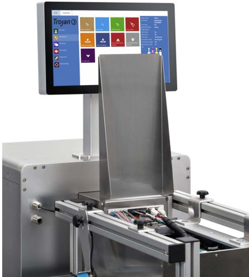
2. Pour un nettoyage manuel humide de la tête d'impression, celle-ci doit être retirée de la Trojan3. Appuyez sur le bouton Libérer tête d'impression dans le menu Trojan3 -> Maintenance, pour désamorcer la tête d'impression et ouvrir le loquet qui la retient.
