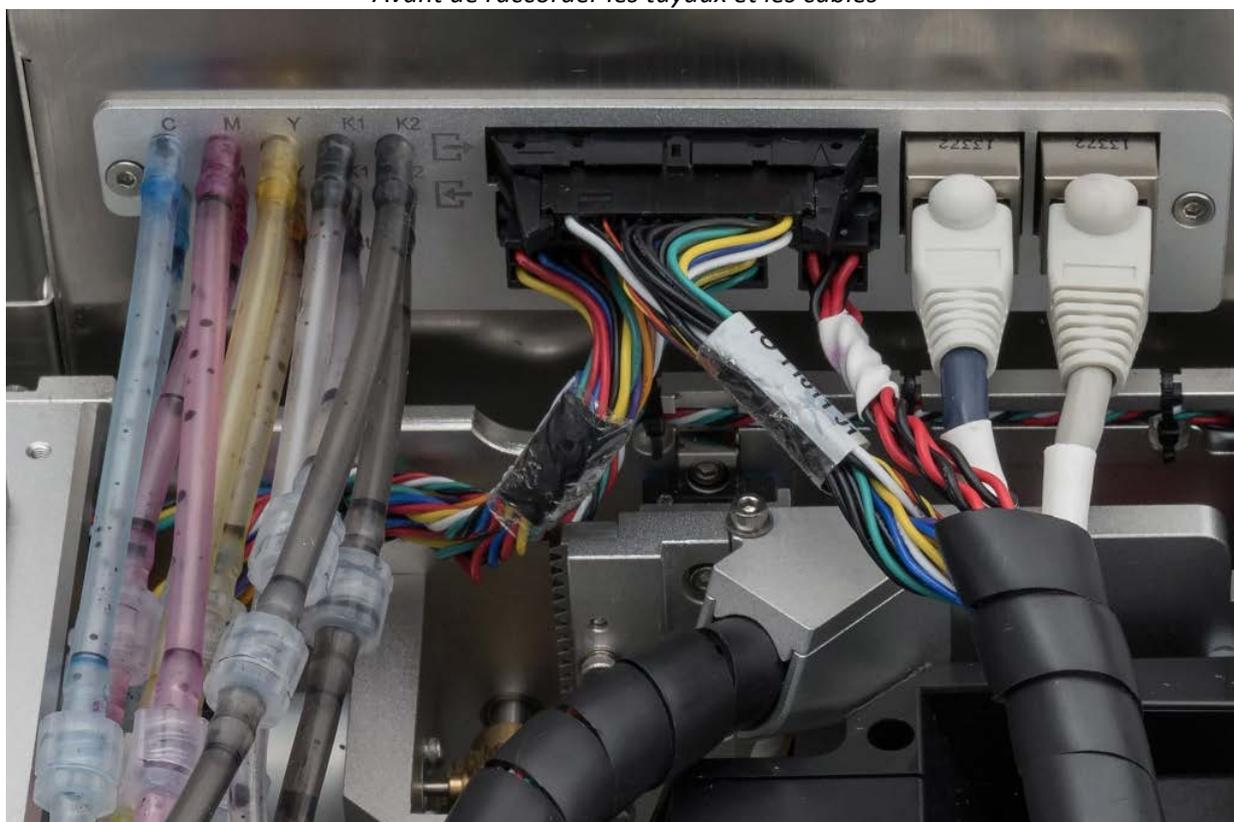
**REMARQUE :** les embouts Luer sont adaptés aux tuyaux d'encre au niveau des conduites d'entrée et de retour, il est donc impossible de se tromper de branchement. Lorsque vous branchez les tuyaux, assurez-
